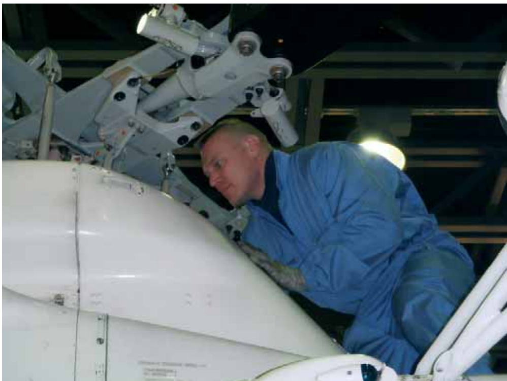
Erityistarkastuksen kohteena pyörivät ja kuluvat osat.
